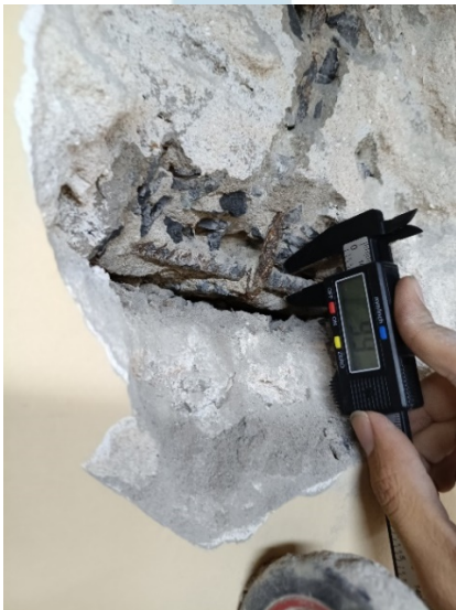
Fotografía 6. Zona 2. (a) y (b) Ensayo de Pachometría en vigas
