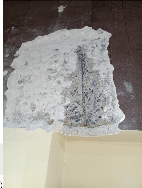
Fotografía 5. Zona 1. Pachometría en vigas.
