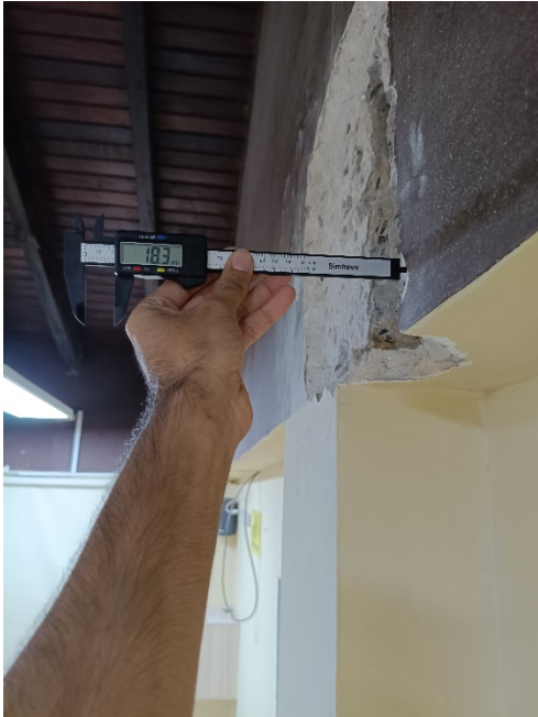
Fotografía 5. Zona 1. Pachometría en vigas.
